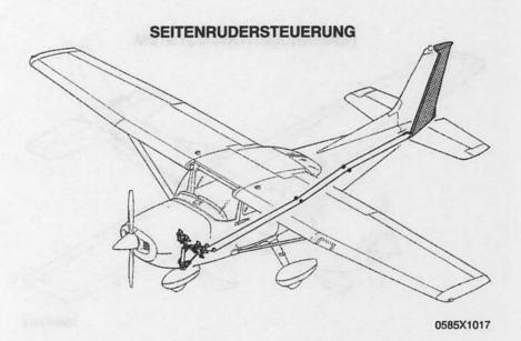
Abb. 7-1 Flugsteuerungs- und Trimmsysteme (Blatt 1 von 2)
